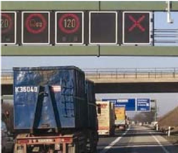
**Abbildung 9: Schaltung nach Räumung des Standstreifens (eigenes Bild)**
