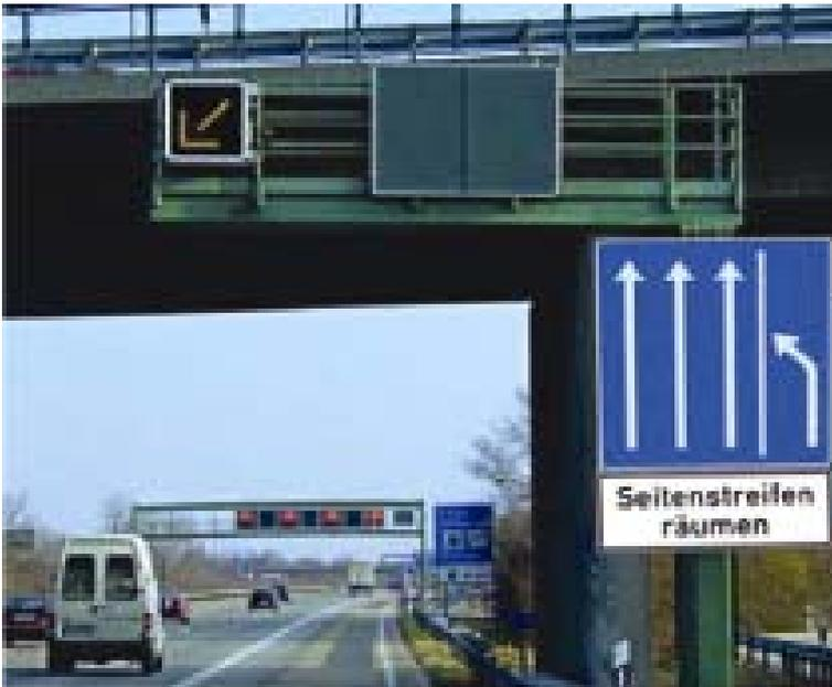
**Abbildung 8: Schaltung am Ende der Standstreifenfreigabe (Autobahndirektion Südbayern)**
