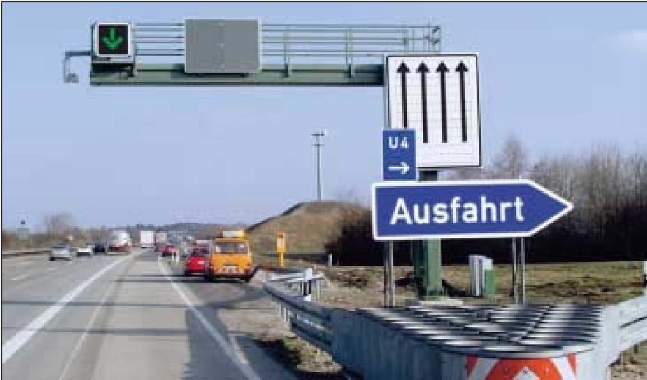
**Abbildung 5: Kragarm mit Videokamera, Dauerlichtzeichen und Verkehrslenkungstafel zur Standstreifenfreigabe und eine Haltebucht (Autobahndirektion Südbayern)**
